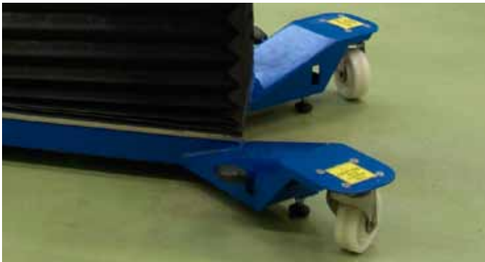
Feststellenrichtung für Rollen auf Rahmen montiert - jederzeit erreichbar
